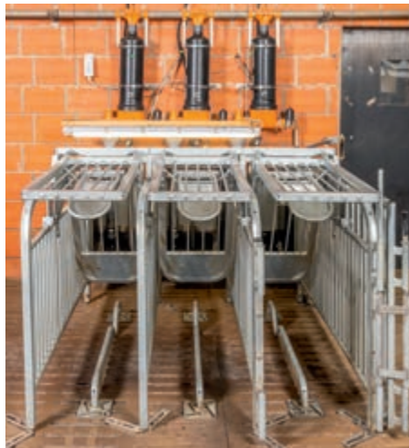
Une barre anti-écrasement empêche que la truie ne reste trop longtemps dans la station
