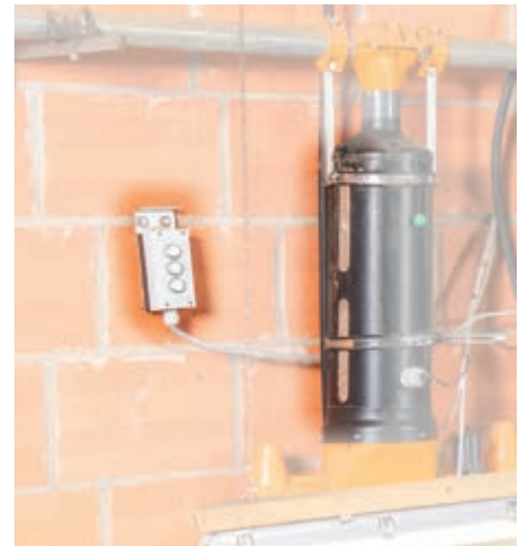
Dosage d'aliments manuel (en option) ; la trémie d'aliments dispose d'un voyant pour le contrôle du niveau de remplissage des aliments
