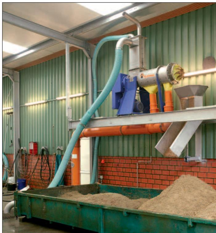
OptiPress II pour les substrats à teneur importante en MS et à structure grossière
