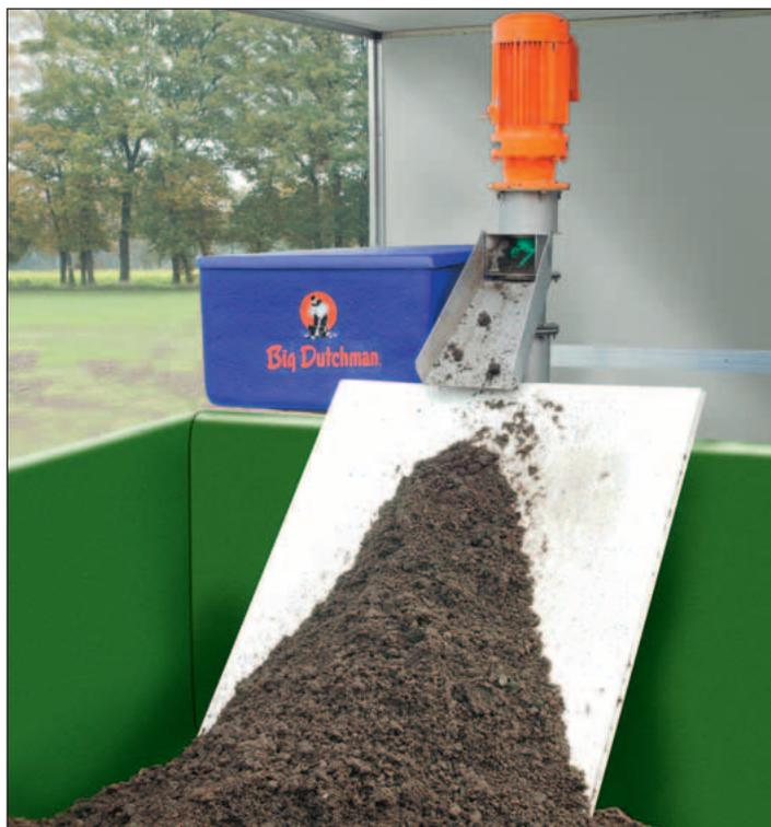
OptiPress I pour les substrats à faible teneur en MS et à structure homogène
