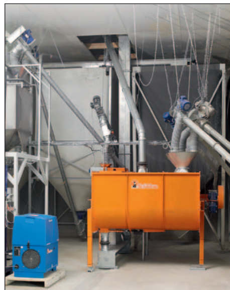
La mélangeuse horizontale envoie l'aliment dans un distributeur de soupe HydroAir
