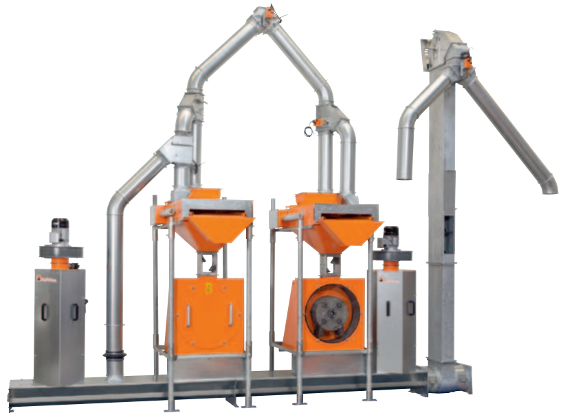
Broyeur parallèle avec deux nettoyeurs séparateurs, deux filtres à poussière (autonettoyants) et un élévateur à chaîne
