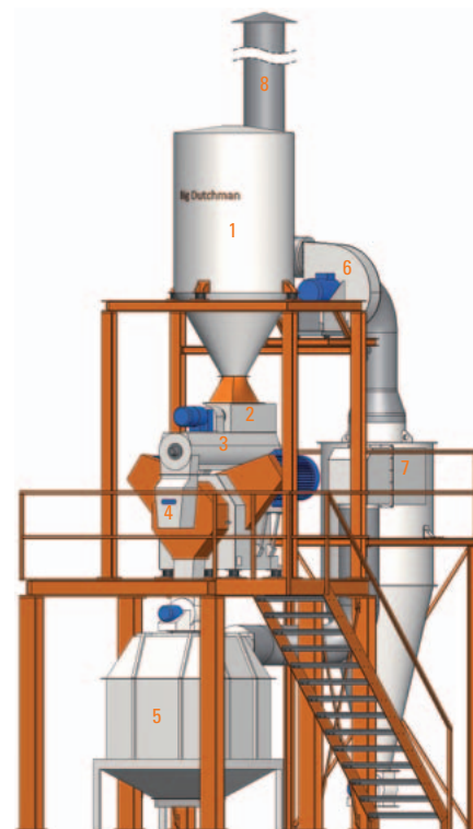
Ligne granulés pour pelletiser l'aliment composé
