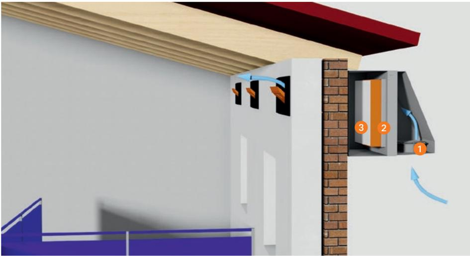
Schéma de fonctionnement de l'APT 1500 pour système de ventilation décentralisée grâce au volet d'aération CL 1200
