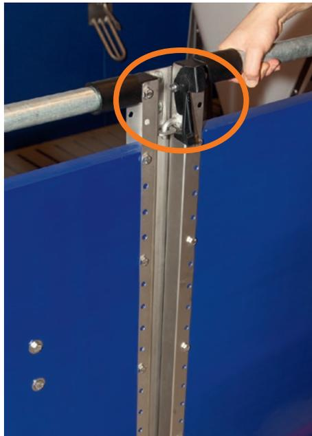
Verrouillage à une seule main – un loquet à diagonale renforcée tombe automatiquement en position verrouillée
