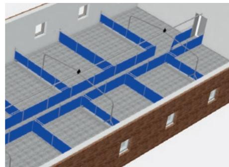
Cases d'engraissement avec porte à double battant et utilisation d'un système d'alimentation soupe
