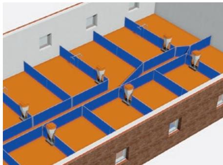
Case d'élevage de porcelets avec couloir en épi et nourrisseurs montés dans la cloison de séparation
